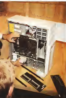
Pieno modulare anche per gli Z-SERVER con come si vede dal hard disk facilmente sostituibile.
